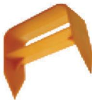
**U-FIX:** Graffa universale per fissare e tenere in posizione i pannelli fino a presa della colla THERMO FIX. Possono essere usate sia sul fronte che sul taglio del pannello, tra pannello e pannello anche ad angolo; mantengono la complanarità, sostengono i pannelli negli architravi. Si rimuovono facilmente dopo la presa e sono sempre riutilizzabili.
